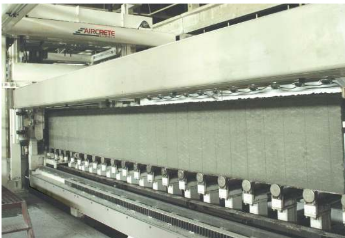
Самый большой завод в Восточной Европе – «Энерджи Продакт», Украина. Высокоскоростная резательная линия (с двумя струнами) и горизонтальное автоклавирование позволяют сделать поверхность любой продукции Aircrete супергладкой
